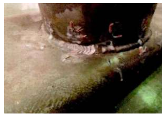
(d) Local buckling failure of the main pipe upper wall and side wall (CS-T4)
